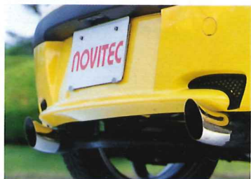
▲マフラーは、左右2本出しでキックアップしたテールが存在感を主張。エンジン本体についてはノータッチで、純正交換タイプのエアフィルターが装着される程度。17インチのタイプN6ホイールの奥に見えるキャリパーは、ブレンボ製の4ポッド。
